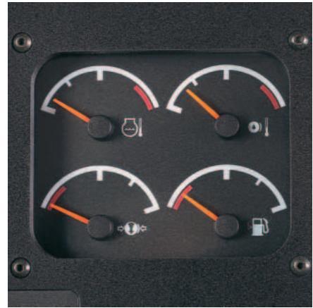
**• Блок указателей.** Обеспечивает постоянное отображение наиболее важных параметров состояния машины, включая: температуру охлаждающей жидкости двигателя, температуру тормозной жидкости, давление масла в двигателе и уровень топлива.
