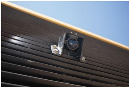
**Телевизионная камера заднего обзора с монитором, установленным в кабине (по заказу).** Телевизионная камера заднего обзора с цветным монитором с длиной диагонали экрана 178 мм (7 дюймов), устанавливаемым в кабине, обеспечивает обзор пространства, расположенного вблизи задней части колесного погрузчика.
