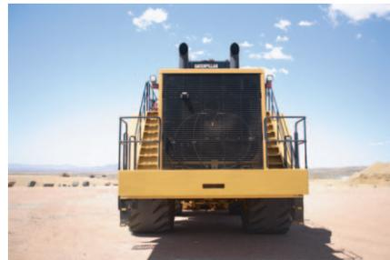
**Более широкие лестницы для подъема на рабочую платформу.** Левая и правая лестницы входят в стандартную комплектацию. Чтобы облегчить подъем операторов и обслуживающего персонала в кабину и для проведения работ по техническому обслуживанию, ширина лестниц была увеличена до 600 мм (23,6 дюйма). Чтобы предотвратить накопление грязи и пыли на ступенях и поручнях, машина может быть оборудована дополнительными крыльями.
