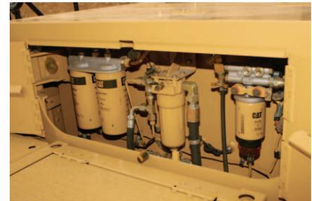
**Зона обслуживания гидравлической системы и двигателя.** В верхней части платформы сгруппированы топливные фильтры, водоотделитель для топлива; фильтры основных контуров, фильтры контура управления, клапан срыва вакуума и предохранительный клапан гидробака системы привода рабочего оборудования. Перечисленное оборудование закрыто откидными панелями.
