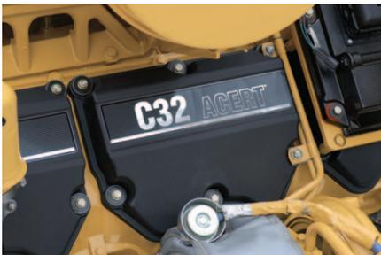
**ПРОВЕРЕННАЯ КОНСТРУКЦИЯ ДВИГАТЕЛЯ.** В погрузчике 993K установлен дизельный двигатель Cat® C32, который полностью соответствует нормам токсичности выхлопных газов EPA Tier 2 (США) и Stage II (ЕС). В системе впрыска топлива данного двигателя используются механические насос-форсунки с электронным управлением (MEU). Данный двигатель также применяется в машинах Caterpillar моделей 777F, 854K, 992K и D11.
