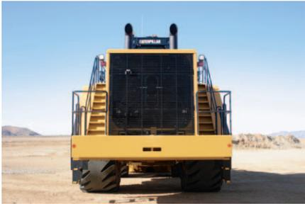
• **Модульный радиатор нового поколения (NGMR).** Радиатор NGMR состоит из 14 модулей сердцевины, установленных параллельно. Такая конструкция позволяет получить более высокую эффективность охлаждения при использовании всего лишь одного всасывающего вентилятора, протягивающего наружный воздух через радиатор.
