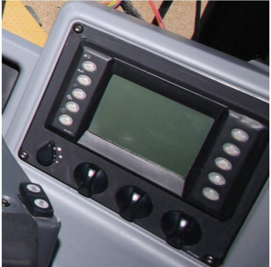
**Система текущего контроля VIMS с улучшенным дисплеем.** Система VIMS контролирует и регистрирует текущие значения более чем 100 параметров машины. Записанные значения параметров используются для технического обслуживания машины и оптимизации ее рабочих параметров. В системе VIMS предусмотрены системные события и события данных, которые формируются для предупреждения о том, что в результате неисправности машины рабочие параметры отклонились от предварительно заданных значений.
