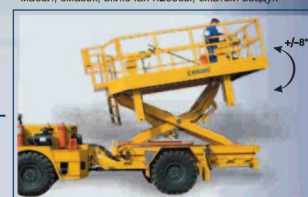
Ножничный подъемник грузоподъемность до 4 т, высота платформы 3,5 м
