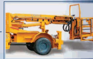
Подъемная рабочая платформа с одной / двумя стрелами, грузоподъемность до 600 кг, рабочая высота до 13 м.
