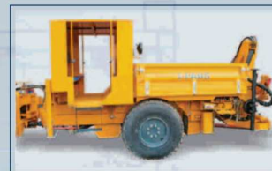
Кабина для людей, кран, грузовая платформа грузоподъемность до 15 т
